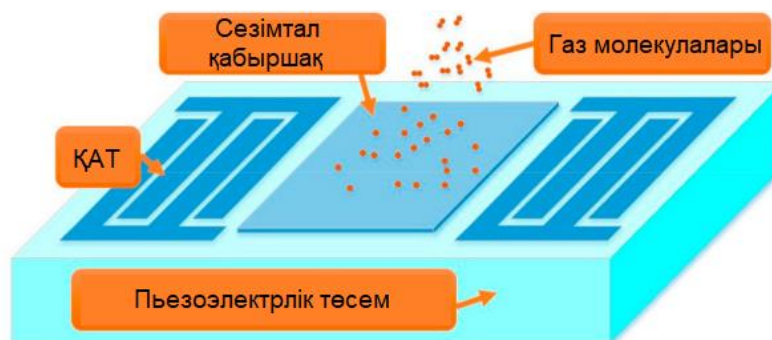
Сурет 1.16. Акустикалық газ сенсорының схемасы [54]
