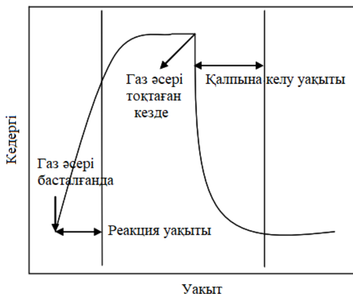
Сурет 1.17. Газ сенсорының газ бөлшектеріне реакциясы [67]
